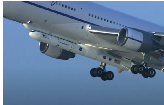
Abbildung 1: Pegasus Rakete beim Start unter dem Flugzeugrumpf (Quelle: NASA's Kennedy Space Center)
