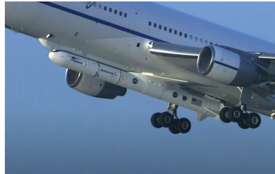
Abbildung 2: Pegasus Rakete beim Start unter dem Flugzeugrumpf (Quelle: NASA's Kennedy Space Center)
