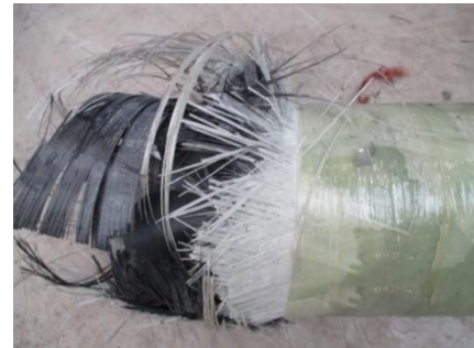
Abbildung 1: Explodierter Gastank mit innerer Kohlefaserstruktur.
